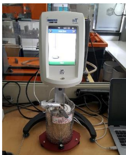
Figure 7: Principe de l'essai pour la détermination de la viscosité dynamique des liants (sources: BFH et bitumequebec.eu)
