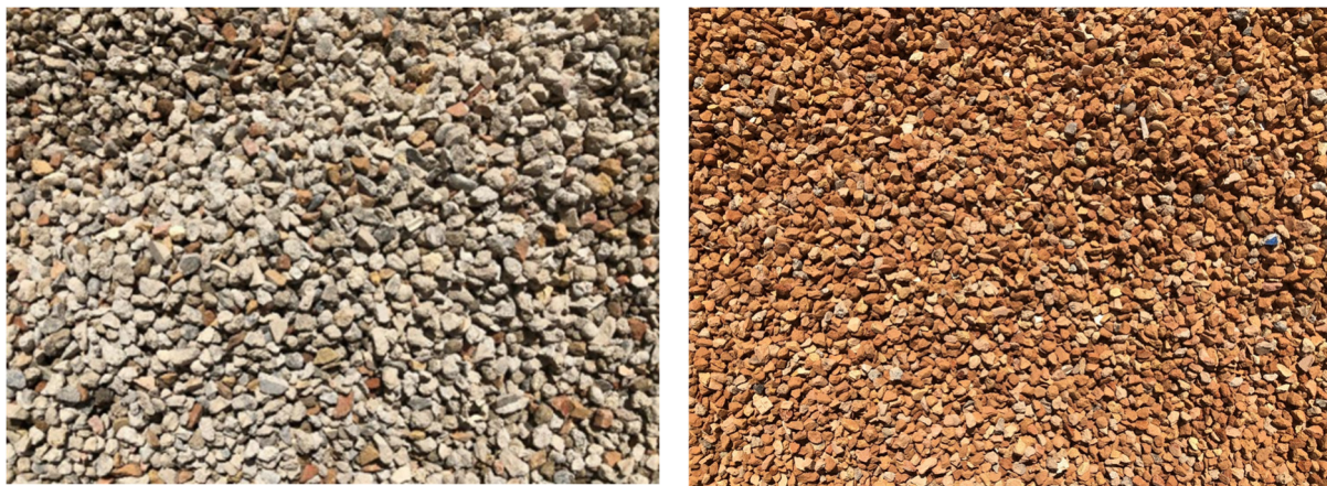
Abbildung 8: Beton- und Backsteingranulate aus einer Nassaufbereitungsanlage mit optisch-pneumatischer Trennung von Betongranulaten und Backstein-/Ziegelgranulaten. Die Trennschärfe ist beeindruckend: Betongranulate enthalten <math><5\%</math> Backsteinanteile und Backstein-/Ziegelgranulate enthalten <math><5\%</math> Betongranulate.
