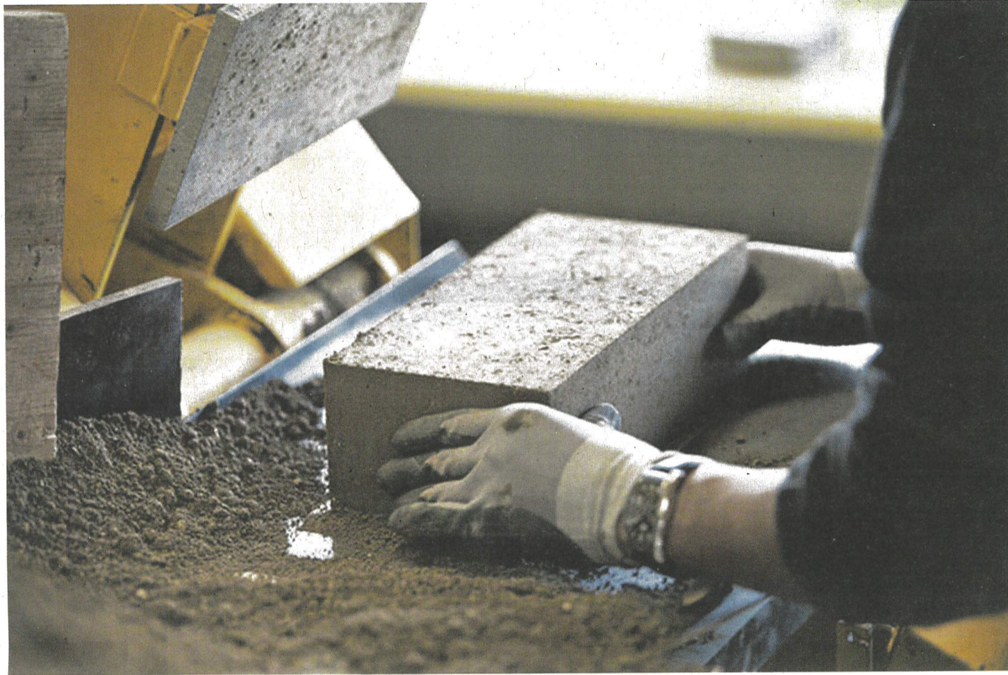
Parmi les solutions alternatives au béton conventionnel, les briques de la société vaudoise Terrabloc, faites à partir de terres d'excavation. Le secteur suisse de la construction reste encore frileux face à ces matériaux. (BARBARA HAEMMIG DE PREUX)
