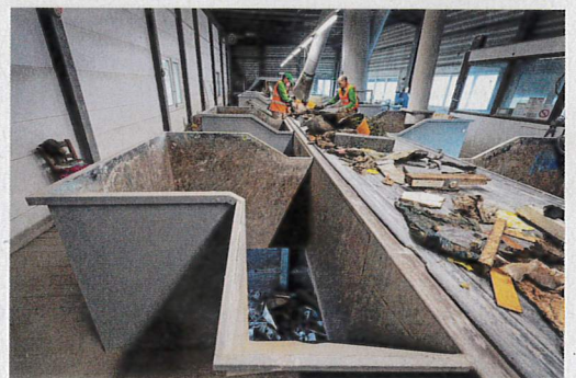
Elektrobagger trennen bei der Firma Debag Steine, Beton und Eisen vom Bauschutt. Siebtrommeln separieren das Sperrgut nach Grösse. Was mehr als 25 Zentimeter misst, wird von Hand sortiert. Aufgelistet – die Preise für den Rohstoff Abfall.
