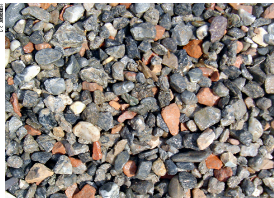
Bei einer konsequenten Aufbereitung des Aushub-, Abraum- und Ausbruchmaterials müsste heute für die Schweizer Betonproduktion kein Kies mehr abgebaut werden (im Bild: Recyclingkies).
