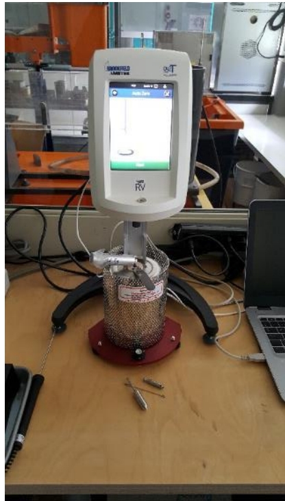
Abbildung 7: Prinzip und Durchführung eines Versuchs für die Bestimmung der kinematischen Viskosität (Bildquelle: BFH und bitumequebec.eu)
