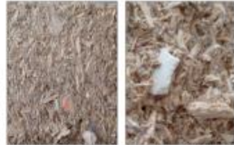
Abbildung 1: Spanplatten bestehen zu etwa einem Drittel aus Altholz. Aufgrund einer teilweise ungenügenden Trennung von Altholz und Jungholz kommt es zu einer Vermischung von Holzarten und Holzarten. Die Fremdstoffe können in Holzwerkstoffen bereits nachweisbar sein. Die Grenzwerte nach AltholzV (2) sind in der Grenzwerttabelle von AltholzV (2) angegeben. In der Tabelle sind die Grenzwerte für Chlor (Cl) ges. Grenzwert 600 mg/kg angegeben.
